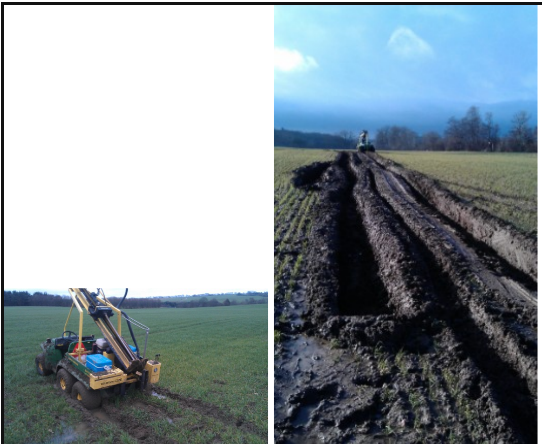
Figur 10a og figur 10b. Billeder af markskader i 2013. Billedet til venstre (10a) viser skade efter fastkørsel med Gatoren. Billedet til højre viser en skade efter fritrækning med traktor (10b). Markskaderne ser voldsomme ud, men det påvirkede areal er lille, og omkostningerne er begrænset til ca. 2000 kr. for alle markskader, der blev lavet i hele prøveudtagningssæsonen. Foto: Sune Petersen, AgroTech.
